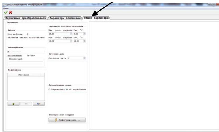
В этом окне вводятся значения температуры холодного источника, начала/конца отопительного сезона, отображается серийный номер вычислителя. **Обязательно необходимо настроить подсистемы учета. Отображаются на экране прибора и архивируются только те параметры, которые внесены в подсистемы.**
