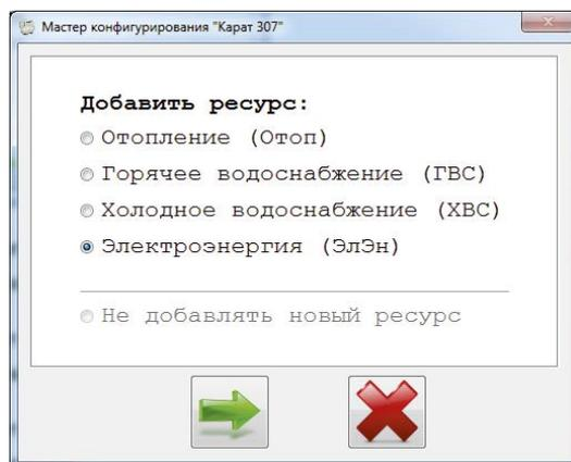
**2.4 Выбираем схему, по которой будет работать вычислитель. Она должна совпадать с узлом учета и количеством приборов, которые будут задействованы в данном ресурсе.**
