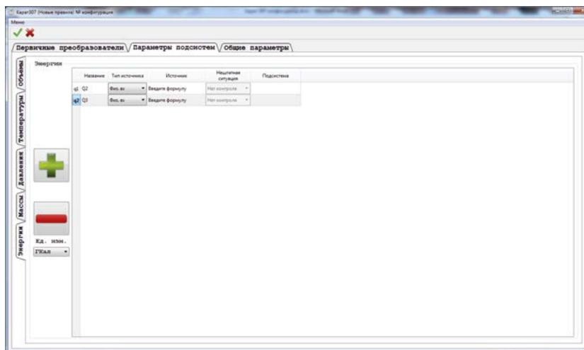
В графе тип источника есть параметры  $Q_{min}$  и  $Q_{max}$  – данные параметры регистрируют максимальную и минимальную полученную тепловую энергию.
